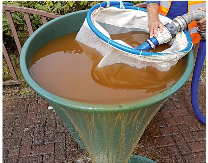
Abb. 5: Regenfass mit eingehängtem Planktonnetz, Beprobung während einer Schirmspülung
