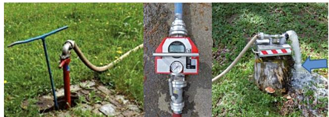
Abb. 4: Aufbau und Materialien der Interstitialbeprobung
