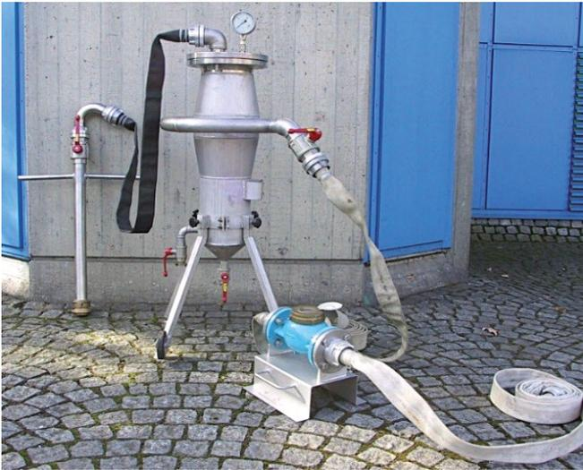
Abb. 4: Rohrnetzprobenahmegerät
